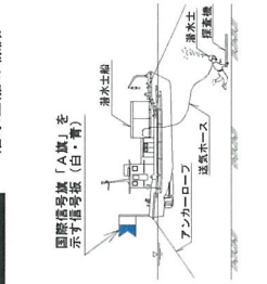
図-3 潜水探査態勢図および潜水士船の標識
